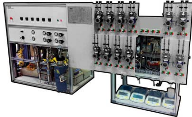
Rys. 7. Przykładowe urządzenie do pomiaru przewodności proppantów [źródło: Grace Instrument]
