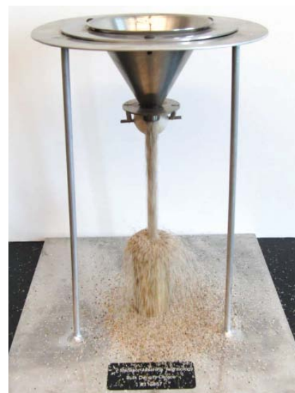
Rys. 5. Urządzenie do pomiaru gęstości nasypowej [źródło: 3]
