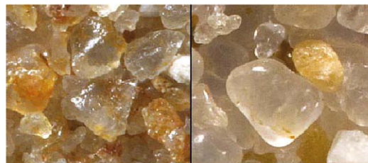
Rys. 2. Wizualna ocena kulistości i okrągłości ziaren proppantów na przykładzie piasku kwarcowego [źródło: 1,2]
