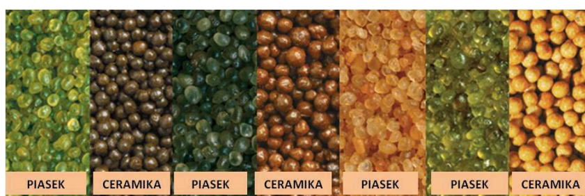
Rys. 9. Przykładowe typy proppantów piaskowych i ceramicznych powlekanymi specjalnymi żywicami w celu poprawy właściwości [źródło: Momentive]
