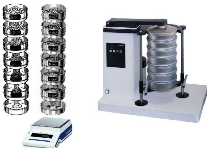
Rys. 1. Typowy zestaw do analizy sitowej proppantów [źródło: 1,2]
